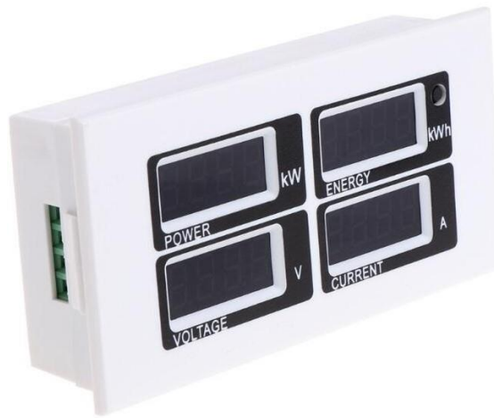
Hình 6: Module đo thông số điện xoay chiều PZEM-004
