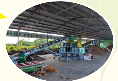
Dây chuyền sơ chế/xử lý chất thải công kênh
