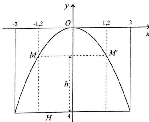
Để cho ô tô có chiều cao lớn nhất có thể đi qua cổng thì ô tô phải đi sao cho trục của ô tô trùng với đường trung trục của 2 chân cổng. Khi đó điểm cao nhất của ô tô trùng với điểm  $M$  trên parabol  $y = -x^2$  nên  $M(x_0; -x_0^2)$ . Vì thùng ô tô có bề rộng 2,4 m nên điểm  $M(-1,2; -1,44)$ . Do đó chiều cao lớn nhất của ô tô có thể qua cổng là
