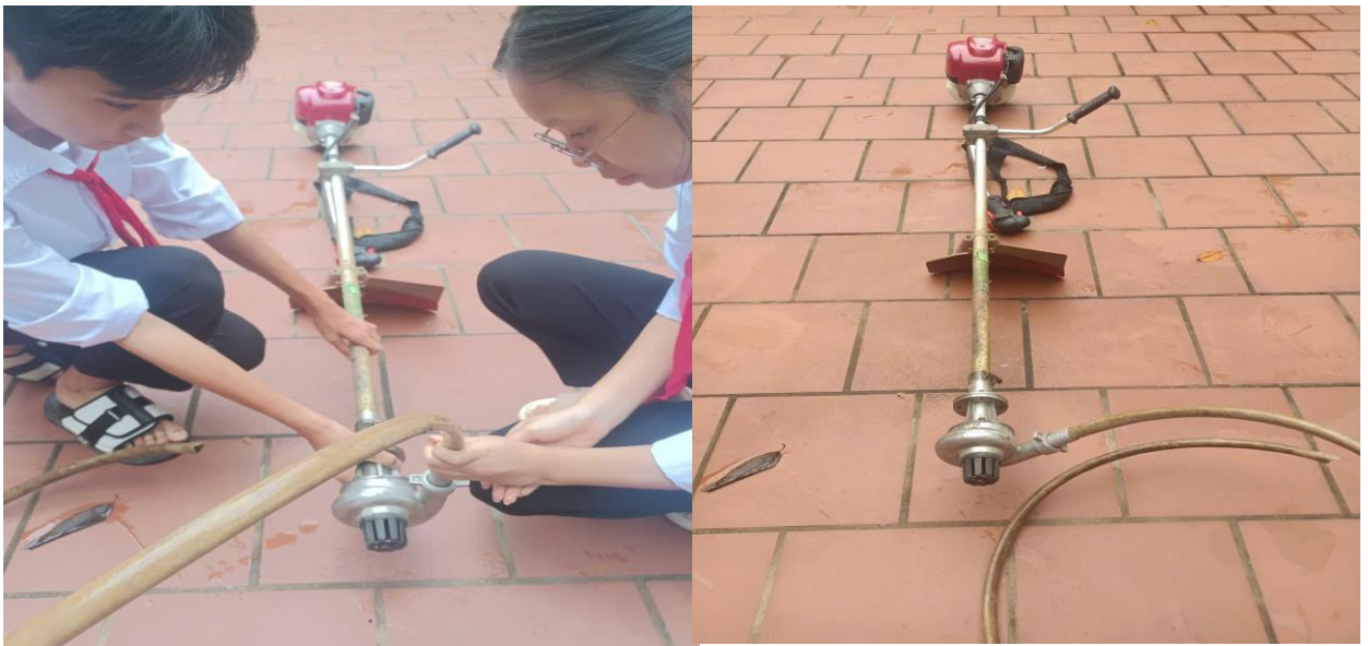
Hình 5. Quá trình lắp ráp máy bơm nước
