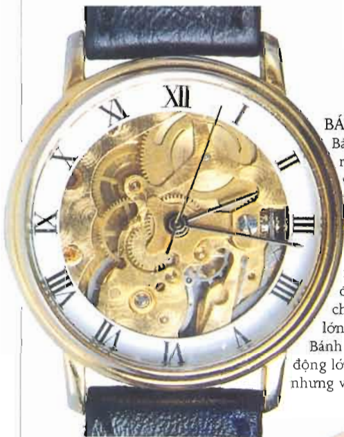
Đồng hồ cơ có các bánh răng để làm quay các kim với tốc độ khác nhau.
